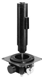
S50JAK-ZT-31R3P (Z軸のツマミ部に直線摺動 型POT.を内蔵したもの。押 ボタンSW付。)
